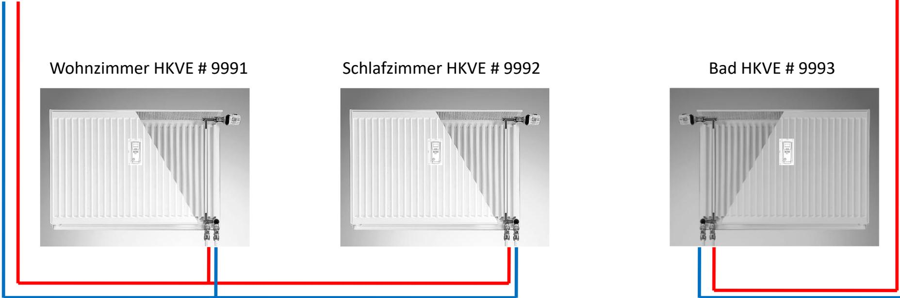
Bei der Montage der Geräte wird die Größe des Heizkörpers und (wenn möglich) der Hersteller bestimmt. Im vorliegenden Beispiel handelt es sich um Heizkörper der Firma Purmo mit den Abmessungen 22 x 600 x 1000 (Typ x Bauhöhe in mm x Baulänge in mm).
